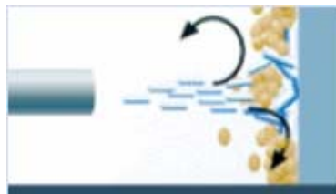
El choque térmico causa dilatación y los pellets desprenden la suciedad del objeto
